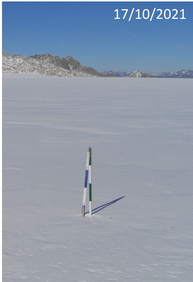
Palina ablatometrica Passo Salarno – Pian di Neve (3130 m. slm.)
